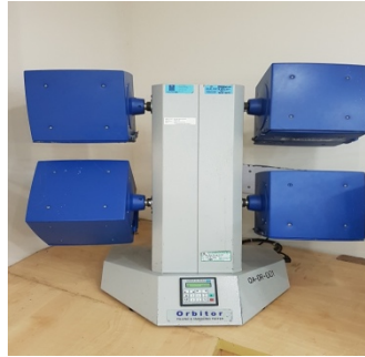
Figure 19 ICI Pilling Box
