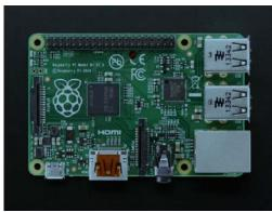
Fig. 01: Raspberry Pi Module
