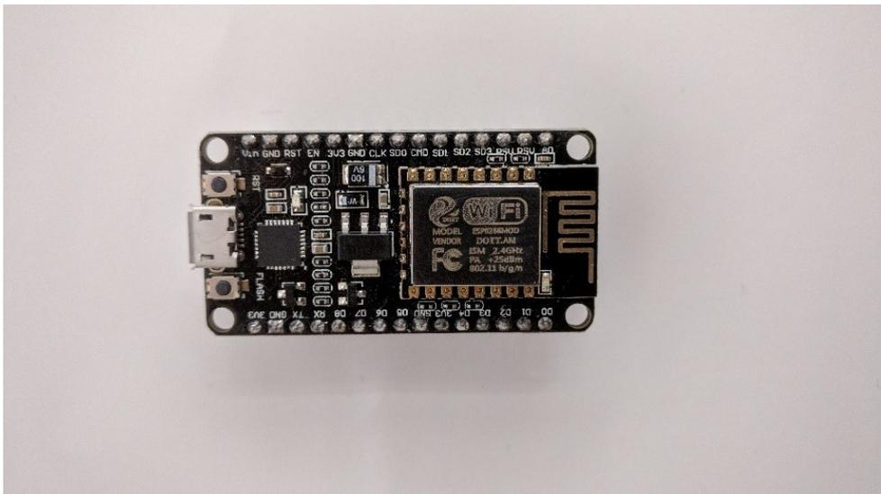
Figure 4.2: NodeMCU ESP8266
