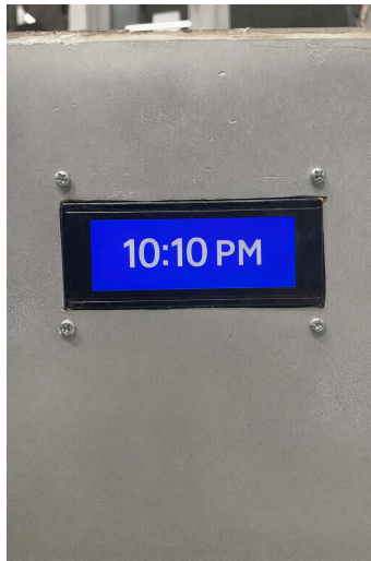
Figure 41: RTC module referencing actual time
