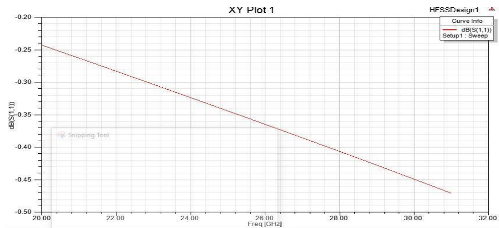
Fig 21a: S Parameter for 1x1 circular patch antenna
