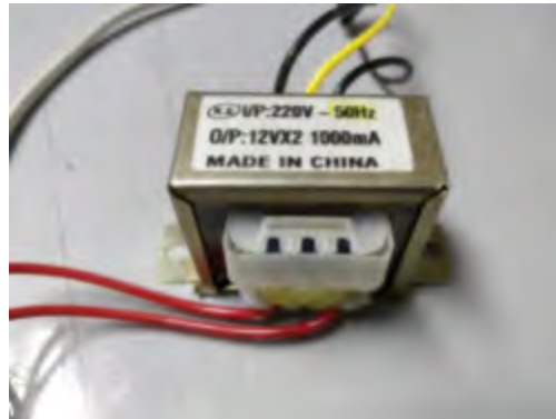
Fig: Step down transformer
