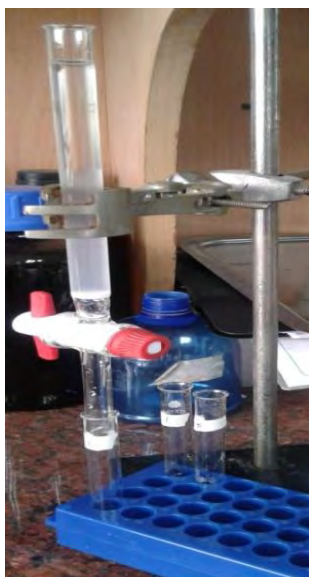
Fig 3.12 : Gel filtration using sephadex G-75
