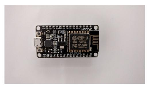
Figure 4.2: NodeMCU ESP8266
